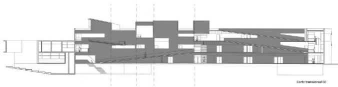
Fig. 35: El muro presenta perforaciones, relacionando los pasillos laterales con el espacio central
